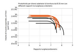
Nuova generazione di adattatori di tornitura Silent Tools™ Generazione precedente di adattatori di tornitura Silent Tools™
